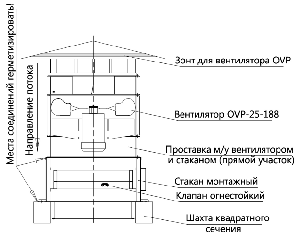
установка на монтажном стакане с огнестойким клапаном
